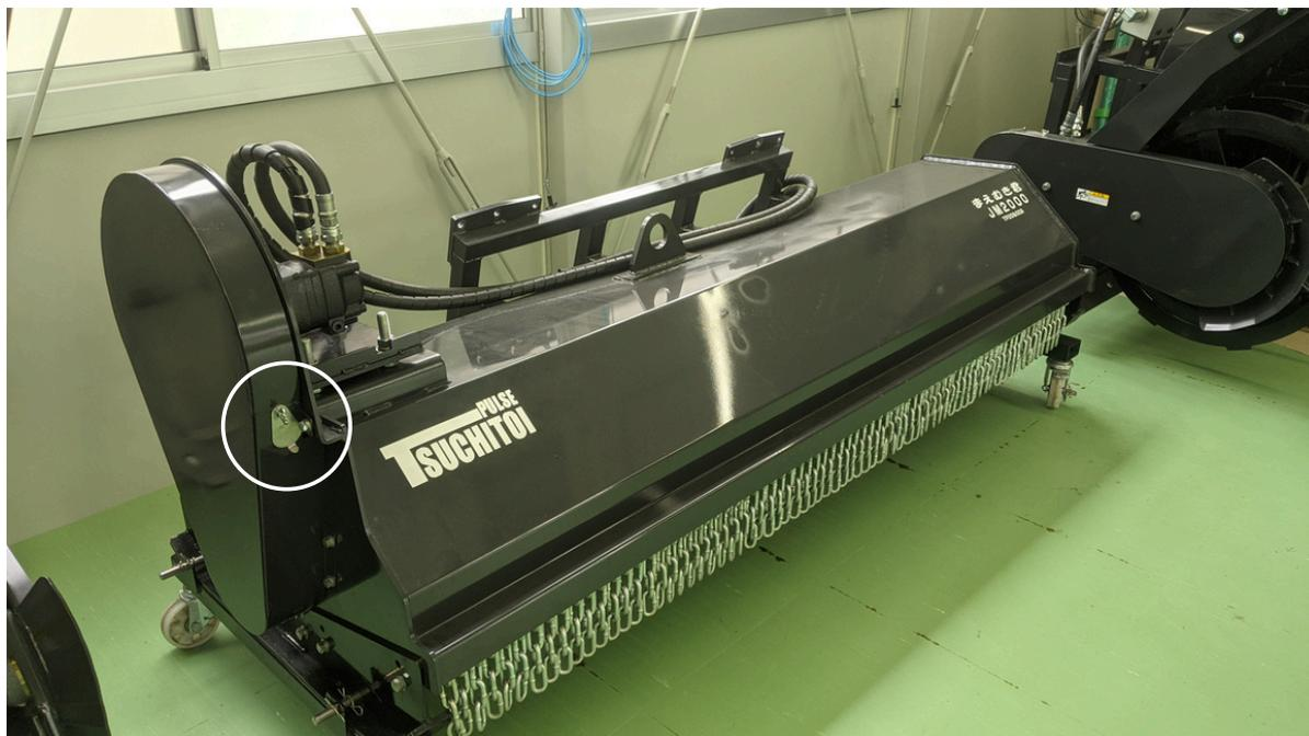
上記の写真の白い丸で囲まれている部分のふたを開け、注油することができます。あけた場合の写真は下記のとおりです。注油の頻度は10時間に1回程度の注油をお願いします。注油をしないと、チェーンが切れるなどの重大な故障につながる危険があります。注油の際は、安全のため必ず注油口から注油してください。
